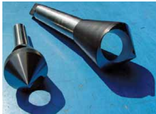
Sbavatori con foro trasversale a 90° (con codolo gambo o conico e cilindrico)
