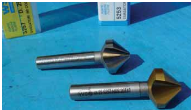
Svasatori a 90° a tre taglienti con gambo cilindrico
